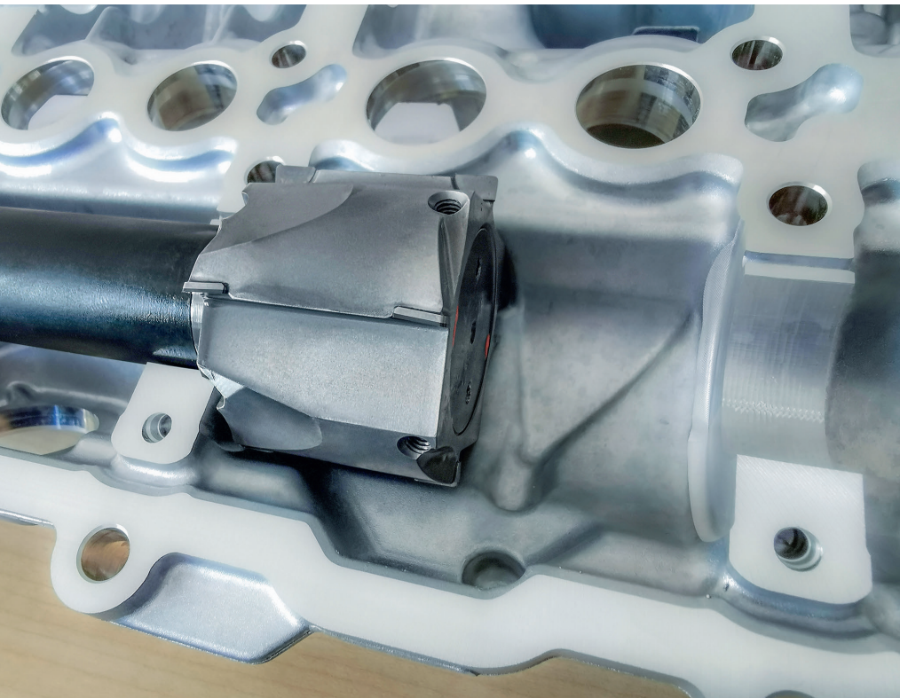
1 Das Bearbeiten von Lagerbock-Seitenwänden mit PKD-bestückten Fräsköpfen ist eine der vibrationsarmen Werkzeuglösungen, die Mapal für SGG gestaltete © Mapal
