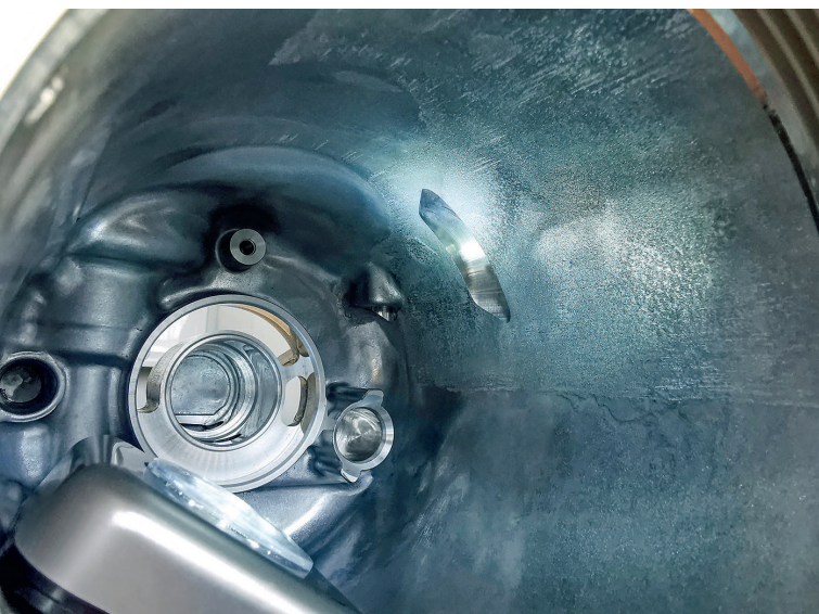
3 Auch das Zirkular-Innenfräsen von etwa 10 mm tiefen Taschen (rechts oben) in Lkw-Kraftstofffiltergehäusen verläuft heute vibrationsarm, nachdem der Fräseschaft neu gestaltet worden war
